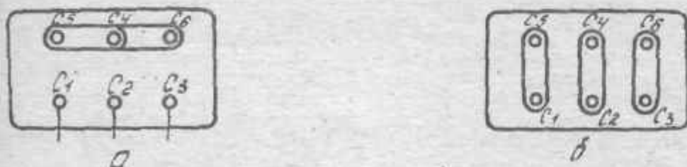
Рис. 23. Схема соединения обмотки статора электродвигателей: а — на звезду; б — на треугольник
