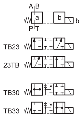
Тип TB*: 1 электромагнит со стороны B 2 положения с возвратной пружиной
